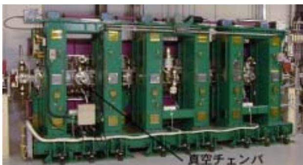
図 10.SPring-8 標準型真空封止 X 線アンジュレータ
