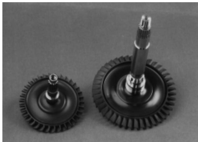
図 8 G G T ロータ, P T ロータの外観
