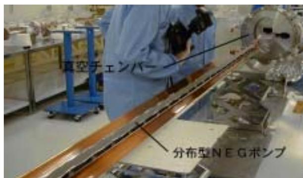
図 12. 分布型 NEG ポンプを挿入
