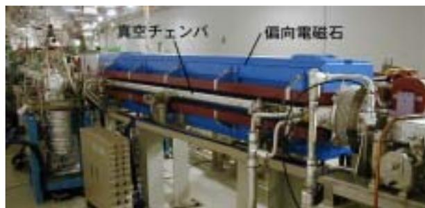
図 8. 偏向電磁石と真空チェンバー
