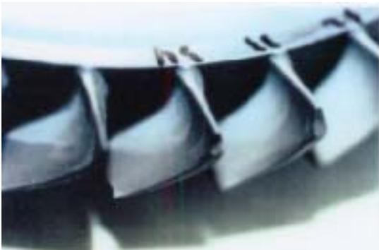
図 15 FOD により先端が欠損したガスジェネレータータービン翼
