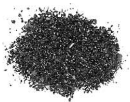
写真3 高温ガス化炉から排出された水砕スラグ
