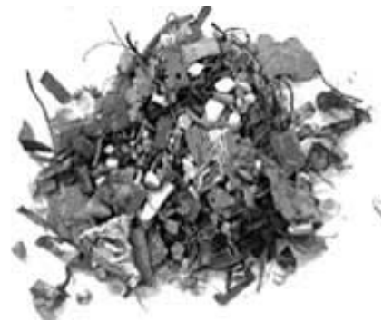
写真2 低温ガス化炉から排出された不燃物
