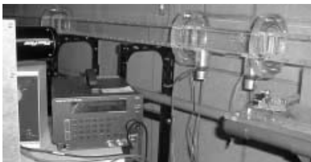
図2 矩形流路: 矩形流路は超音波振動面を除いてはアクリル製である. 振動子はそれぞれ独立に動作可能であり, 下部の振動面(ステンレス板)に種々の振動モードを形成させることができる.
