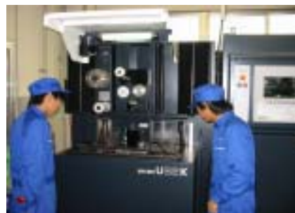
写真3 CAD/CAMによるワイヤ放電加工
