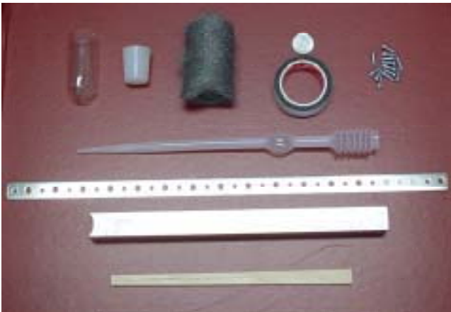
図3 ポンポンエンジンの材料
