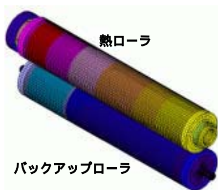
図7 解析モデルと計算結果の一例 （カット紙用定着装置）
