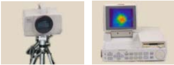
図2 サーモビューアー (左:カメラ, 右:本体) 温度が低い 温度が高い
