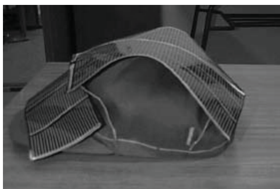
図 13 野球帽形電子冷却帽子 (試作 2 号機) 7)
