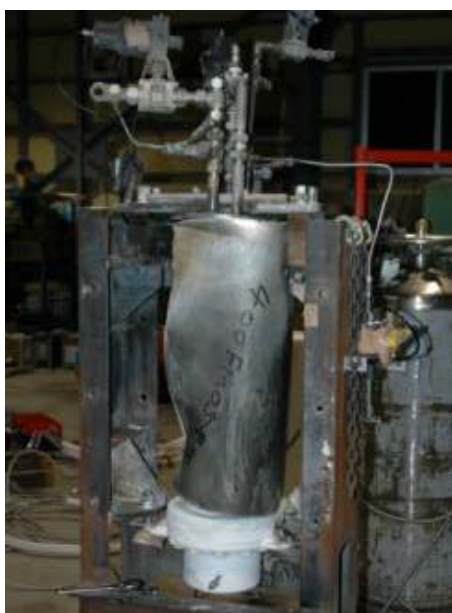
図 8 異常燃焼後のモータの外観
