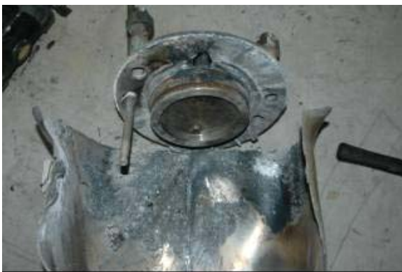
図 7 異常燃焼後の噴射器周辺の外観
