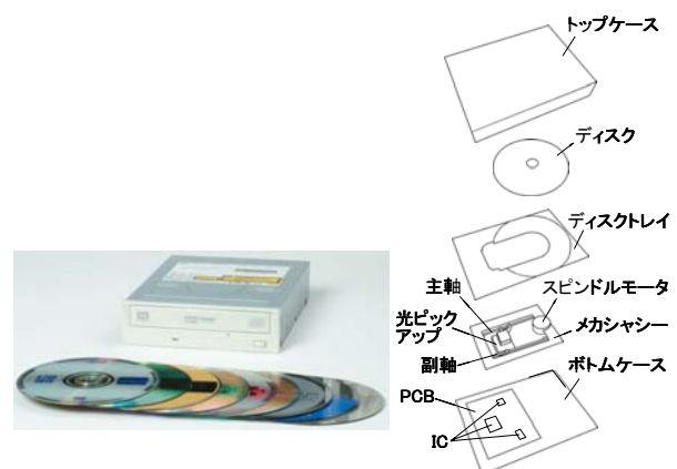
図 8 光ディスク装置の概観および内部構成
