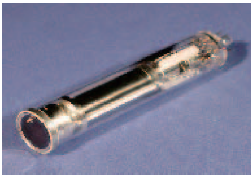
HARP 撮像管は筒形をした真空管です。光電変換部は撮像管の先端部（左側）に位置し入ってきた光をアバランシェ増倍する。
