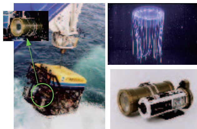
深海無人探査機ハイパードルフィンに搭載したHARPカメラと撮影された深海に暮らすくらげを示す。
