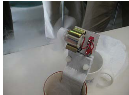
図1 熱電発電の様子(牧野研究室(京都大学)にて)。お湯を入れたコップから液体窒素を入れたコップに流れる熱を利用して熱電発電し、小型モーターが回転している。
