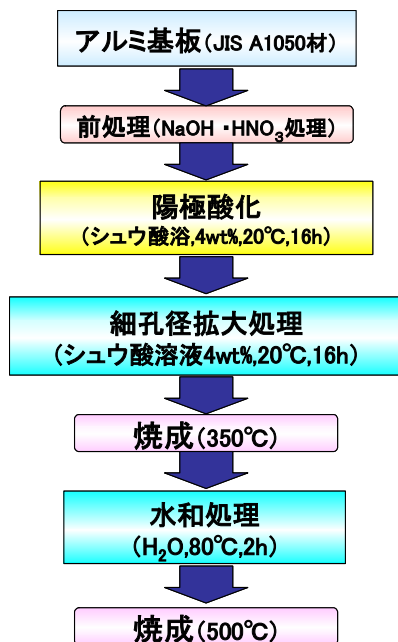
図4 アルマイト担体調製方法の一例
