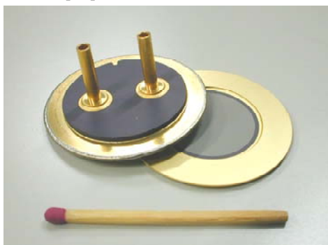
図 12. 試作したマイクロ触媒燃焼器プロトタイプ[22]
