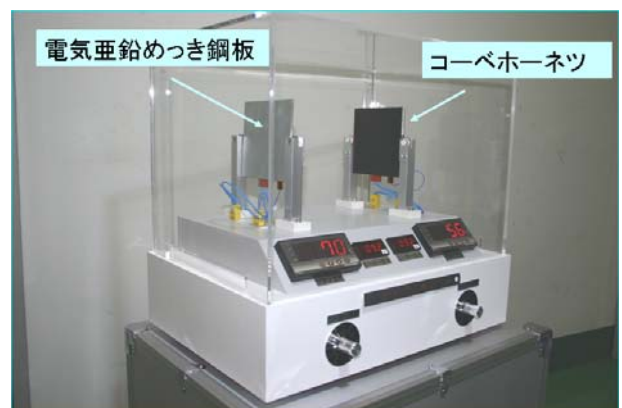
写真1 放熱性鋼板の放熱板としての性能確認
