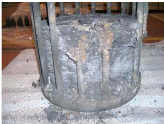
図7 電解セルの破損状態 [5]
