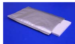
図4 真空包装前の芯材と外被材
