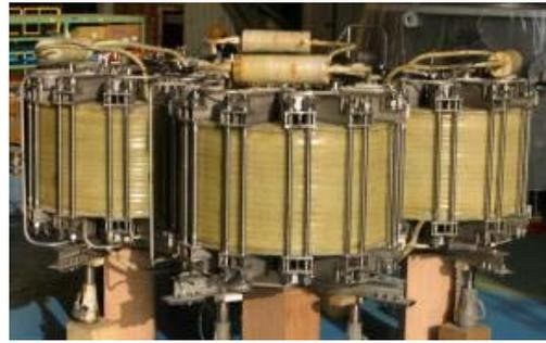
図3 強制冷却方式要素モデルコイル
