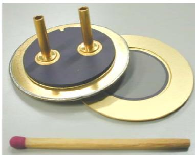
図2 マイクロ触媒燃焼器プロトタイプ [8, 9]
