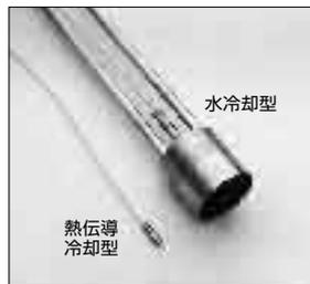
センサー本体の構造は、薄膜フォイル・ディスクの中心と周囲の温度差を測定する、差動型熱電対をとっています。フォイル・ディスクはコンスタンタンで作られており、銅製の円柱形ヒートシンクに取り付けられています。水冷式は取付け場所の自由度が高く長時間の測定が可能です。
