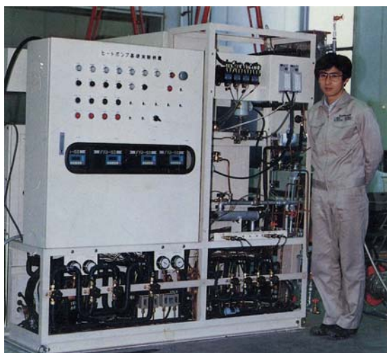
加熱能力4kW, 1987年設置 図2 2段圧縮式原理試作機
