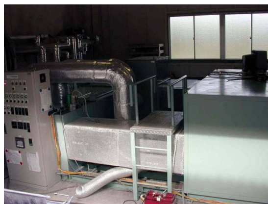
加熱・冷却能力 5kW, 1999 年設置 図 6 試作機試験風洞
