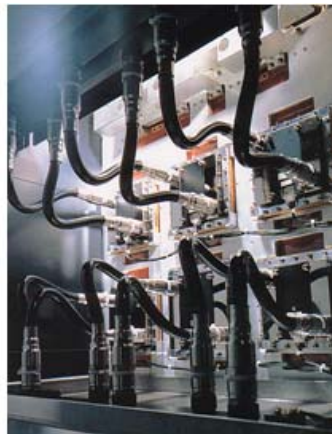
図 23 水冷マルチチップモジュールと母基板前 の水配管 (日立 M880, 1990 年[60])
