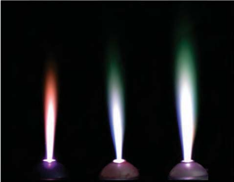
図1 水プラズマトーチで発生したプラズマジェット（左から水，メタノール水溶液，エタノール水溶液）
