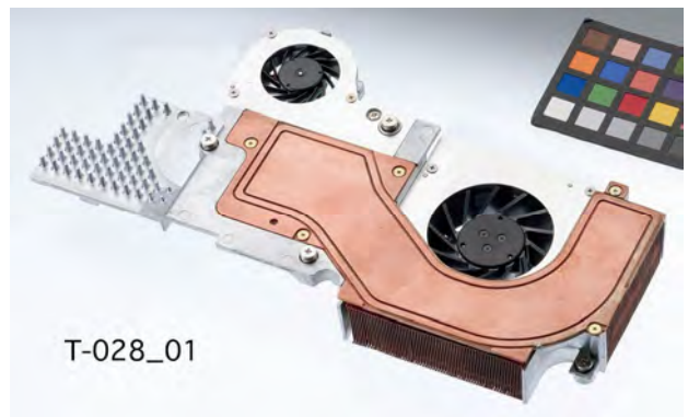
図10 PC冷却用平板型ヒートパイプ (フジクラ 望月氏提供)
