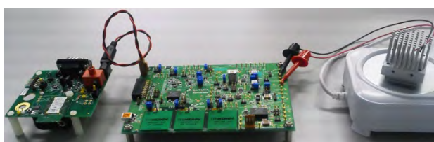
図 14 温度差発電による WiFi センサーネットワーク
