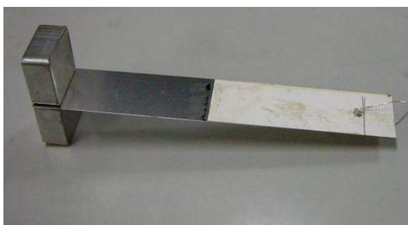
図2 圧電素子を使ったカンチレバー型発電デバイス
