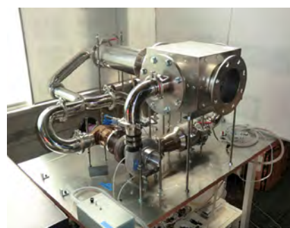
図2 混合ガスタービンシステム (外燃式ガスタービンシステム) 試験機
