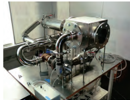
(d) 外燃式ガスタービン試験機
