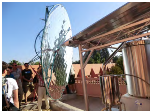
図3 インド農村に多数導入されたシェフラ式ディッシュ太陽集熱装置
