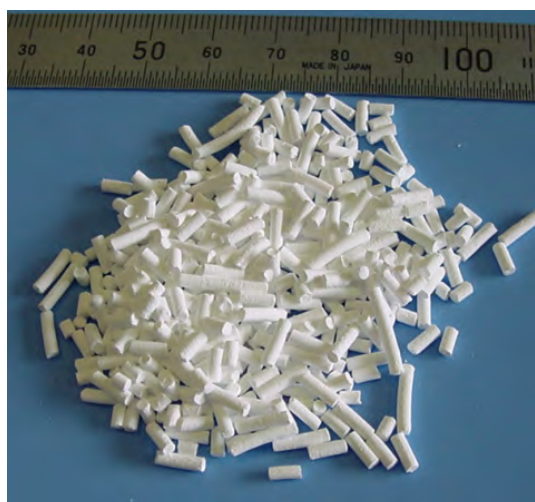
図 3 開発された高い繰り返し反応耐久性を有する水酸化マグネシウムペレット ( \phi 1.9 \times 5 \sim 10 mm)
