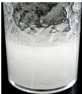
左図：過飽和 LiBr 水溶液の結晶成長状態
