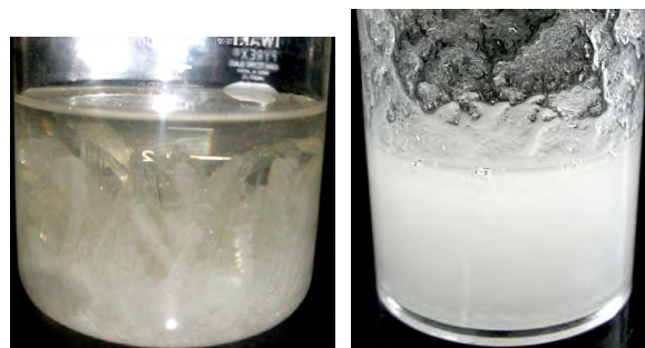
(a) ゼオライト分散無 (b) 微細結晶スラリー 図 5 過飽和結晶状態
