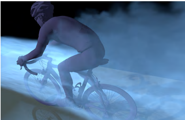
図 6 走行中の自転車周りの流れのトレーサ粒子による可視化
