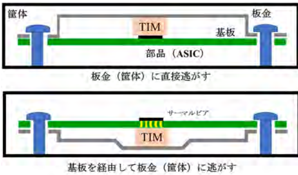
図6 板金（筐体）に熱を逃がす対策
