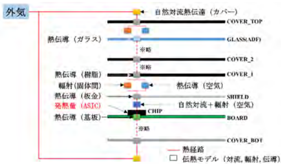
図4 メイン基板周りの熱回路網モデル
