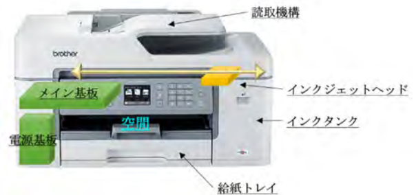
図 3 メイン基板の搭載位置 (MFC-J6583CDW)
