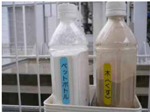
写真 3 熔融炭酸塩型燃料電池に供給される有機廃棄物高温ガス化ガスの原料粉末(粒径は数 100 μm 程度)
