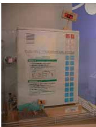
写真 7 各種燃料電池。上段は電力館の SOFC, 下段はガスパピリオンの定置型 PEFC
