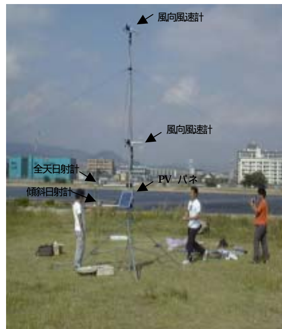
図7 屋外調査風景(西宮市,平成14年10月)
