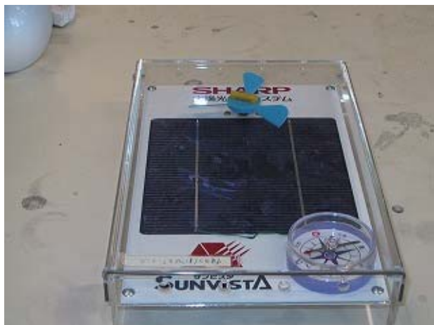
図1 太陽電池セル1枚とファンを組み合わせた模型
