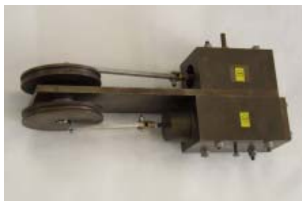
図2 モデルタイプの空気機関
