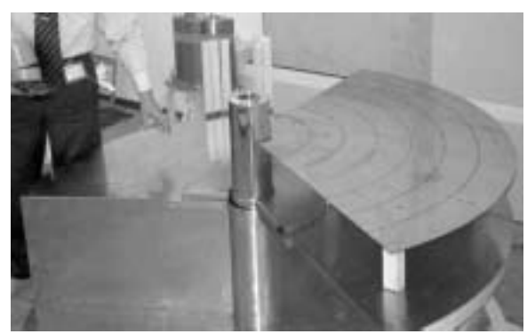
図 1 京大炉コバルト線源 .真ん中の円筒がコバルト線源容器 .使用時には地下から線源が上昇する .少し見にくいが見えが円筒容器向こう側にある 3 枚の細い板に試験片を貼り付けて照射準備をしている .円筒容器中心にあるくぼみ内だと線量が高いが ,このような離れた線量の低い状態だと 1 ヶ月以上照射しないと放射線誘起表面活性による濡れ性の変化は生じない .
