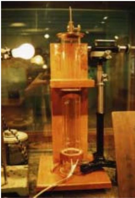
図2. 人工雪製作装置
