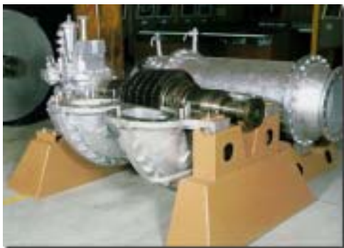
写真 10 北斗丸 500 馬力オーブ・サイクルガスタービン 昭和 29 年(1954) わが国最初の船用ガスタービン
