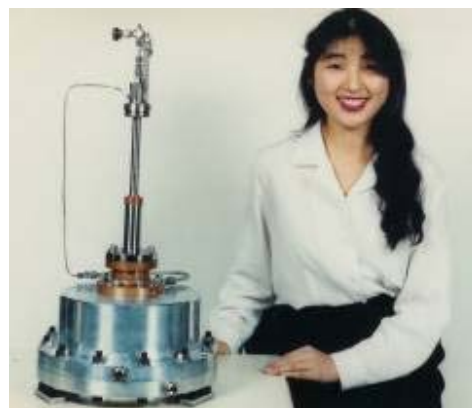
図 15 1 段パルスチューブ冷凍機
