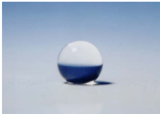
図7： 超撥油性酸化アルミニウム表面上における菜種油。接触角は 150^\circ
