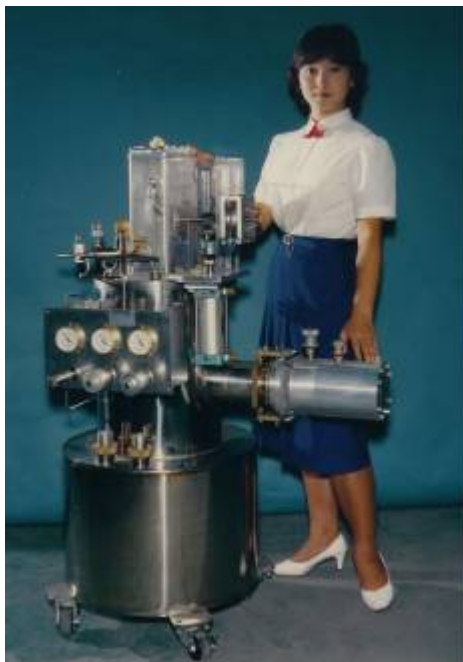
図6 ピストン駆動方式磁気冷凍機
