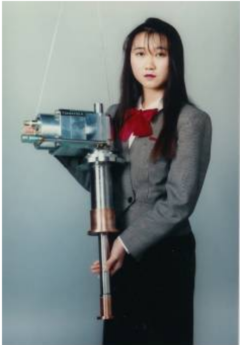
図 11 二段膨張式極低温冷凍機
