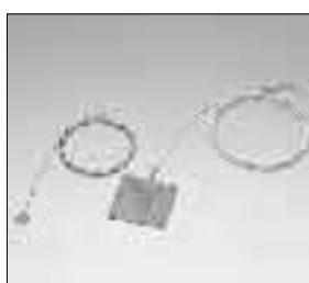
センサーは銅とニッケルのサーモパイルから構成されており、測定対象物に貼付けて使います。センサーは厚さが0.2mmと薄いので、柔軟性に富んでおり、直径1インチの円筒形に湾曲させる事が出来ますので、パイプなどに貼り付けてお使いになるには最適です。
