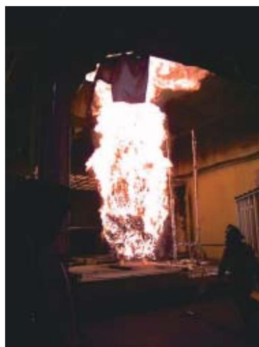
Large Fire Facilityでの樹木の燃焼試験
