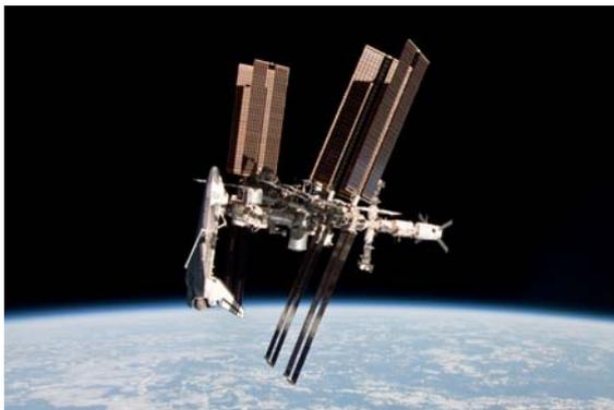
図 13 国際宇宙ステーションの太陽光パネル（上に展開）と放熱ラジエーター（下に展開）。（スペースシャトルがドッキングしている。）(©NASA)
