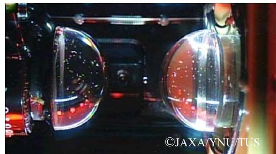
図17 液柱を分離させて形成した対向二液滴。二液滴の間に、分離の際に発生したサテライト微小液滴も見える。
