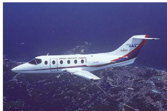
図 6 微小重力実験に用いられるジェット機。20 秒間の微小重力が得られる。機体に、Micro Gravity Flight の文字が見える。（ダイヤモンドエアサービス（株）による）
