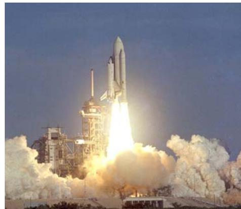
図 2 最初のスペースシャトル、コロンビア号の打ち上げ (1981 年)。初期においては、太陽光熱による温度上昇を抑えるため燃料タンクが白いのが特徴。(©NASA)
