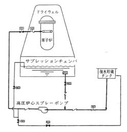
図 8 BWR 高圧炉心スプレィ系系統概念図[4]
