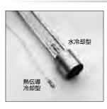
センサー本体の構造は、薄膜フォイル・ディスクの中心と周囲の温度差を 測定する、差動型熱電対をとなっています。フォイル・ディスクはコンスタンタン で作られており、銅製の円柱形ヒートシンクに取り付けられています。水冷式 は取付け場所の自由度が高く長時間の測定が可能です。
