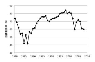
図 2 原子力発電所の設備利用率の推移
