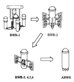
図3 BWR 原子炉タイプ [文献5, 第8回 (Vol.50,No.5)]
