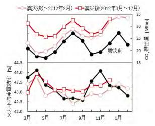
図2 火力発電効率とCO<sub>2</sub>排出量の推移 平均発電効率=火力発電量÷ (燃料種別ごとの 物量×発熱量)
