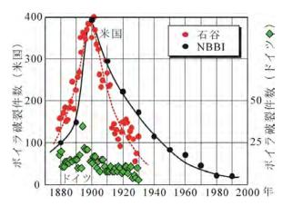
図 5 米国およびドイツにおけるボイラ破裂 件数の推移[13-15]
