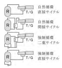
図 2 BWR のシステム構成 [文献 5, 第 6 回 (Vol.50,No.3)]
