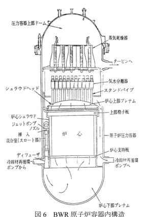
図 6 BWR 原于炉谷器內構造 [文献 5, 第 8 回(Vol.50,No.5)]
