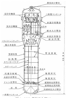
図 5 PWR 蒸気発生器[4]
