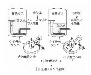
図 7 APWR の高性能蓄圧タンク [文献 5, 第 13 回 (Vol.50,No.10)]
