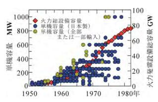
図 6 戦後建設された火力発電所の単機容量(参考文献[25]に基づいて作成)
