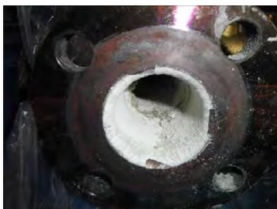
図5 ガス冷却器出口の付着物
