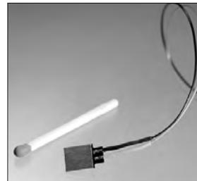
「gSKIN®」熱流束センサーはセンサー自身の表面を通過する熱流束を29対の超高感度な熱電対を用いて測定します。センサーは、 $72m^2$ の広さを持ち、厚さは $0.4mm$ です。レベル-0パッケージの最適化ポリマーと1-レベルパッケージの金属の構造になっています。
