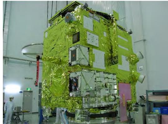
図2 金星探査機「あかつき」(銀色の部分がラジエータ、金色の部分は多層断熱材)
