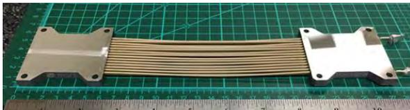
図6 自励振動ヒートパイプ型ストラップ[10]
