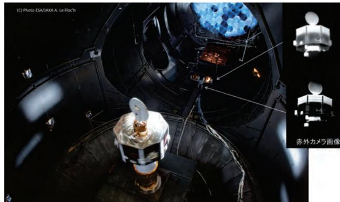
オランダ ESTEC の Large Space Simulator を用いて行われた水星探査機の熱真空試験の様子．水星環境では太陽光熱入力の影響を正確に把握する必要があり，試験に用いられる熱モデルはフライトモデルと熱的に同等のもの（特に形状）とした．集光光ではあるものの水星における太陽光強度（地球近傍の 11 倍）を照射し，高温耐性を評価した．
