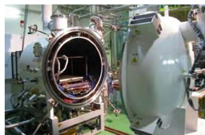
図6 内惑星熱真空環境シミュレーター
