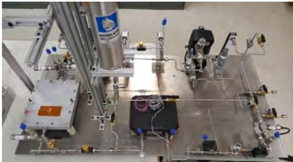
図 7 NASA JPL で開発中の二相流体ループのプロトタイプ[39]
