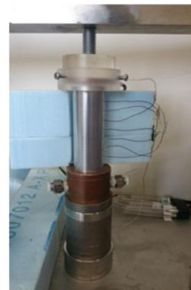
図2 円柱の接触熱抵抗測定（ASTM D5470）
