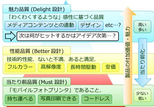
図 9 モバイルフォトプリンタの狩野モデルに基づく品質設計マップ (2019 年現在)
