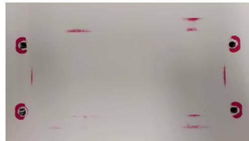
図6 感圧紙による圧力分布の可視化結果
