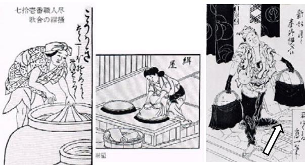
図 12 藍染めの温度管理の変遷。左：（室町時代）甕は大気中に設置。中央：（元禄年間）土中に埋めて保温。右：（文政年間）火壺と呼ばれる加熱装置（矢印）が加えられている[10]。
