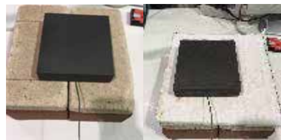
図 1 レンガの上に直接置いた約 4×4×1 inch の鑄鉄塊(a)と断熱材の上に置いた鑄鉄塊(b)の様子
