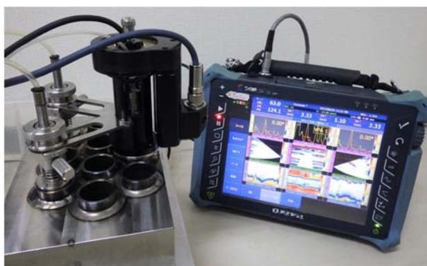
図1 管端溶接部 PAUT 装置
