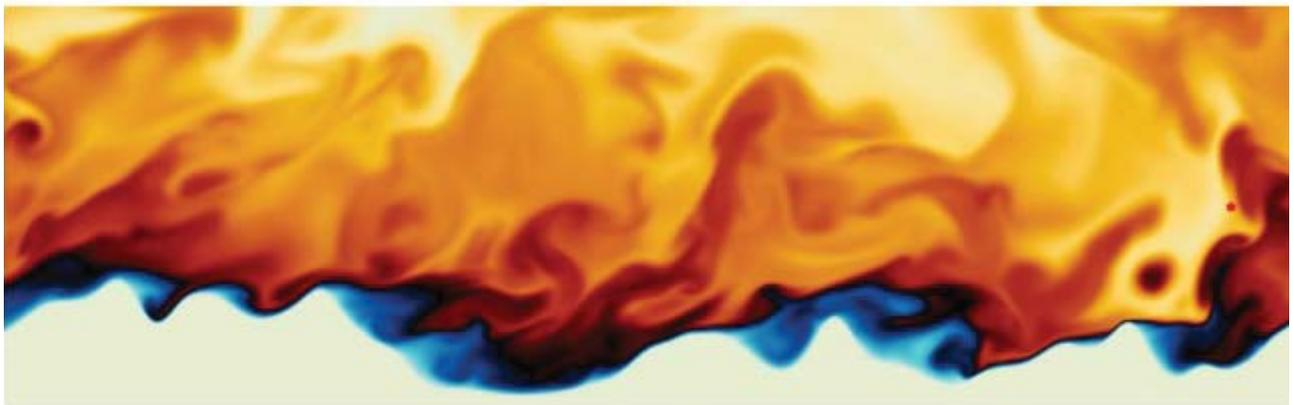
摩擦レイノルズ数  $Re_\tau = 550$ , 粗さレイノルズ数  $k_t^+ = 280$  の粗面乱流熱流動の瞬時温度場. 壁温は一定で, 流体は一様発熱条件. 青と赤は低温領域と高温領域を示し, 主流は右向き. 格子ボルツマン法による DNS. (特集記事「粗面の乱流熱伝達のスケーリング(桑田祐丞, 須賀一彦)」より)
