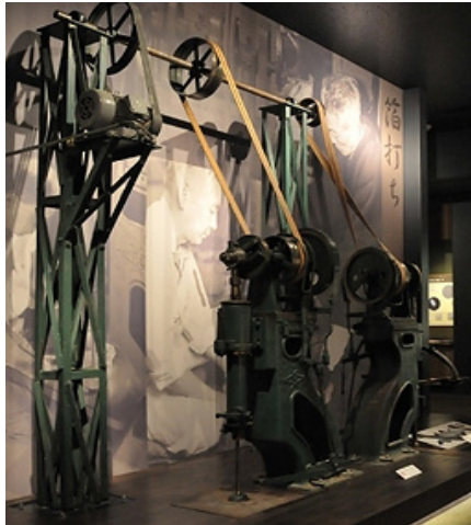
図 14 三浦彦太郎が製作した箔打機 [15]
