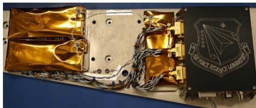
図6 X-37 搭載軌道上実験用 OHP[7]
