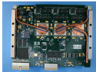
図3 通信機器内部へのヒートパイプ適用[3]
