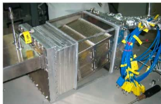
図 4 予冷ターボ用プリクーラ (チューブが見やすいように仮にアクリルのケースを取り付けている。)
