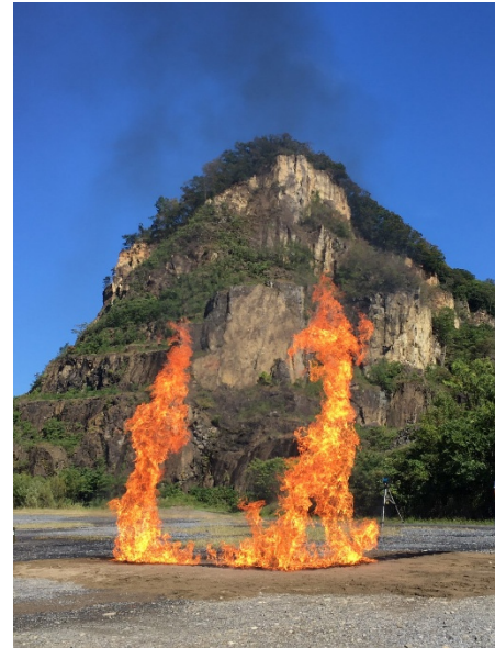
図5 模型実験により再現された火災旋風の例[8]
