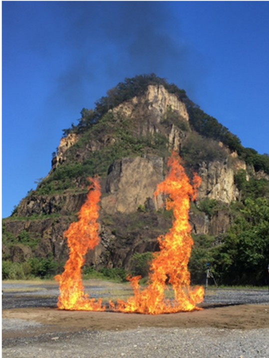
模型実験により再現された火災旋風の例（特集記事「火災現象のスケール効果（桑名 一徳）」より
