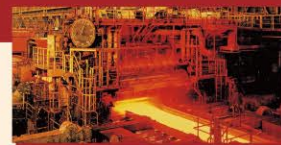
圧延される1000°C超の厚鋼板
